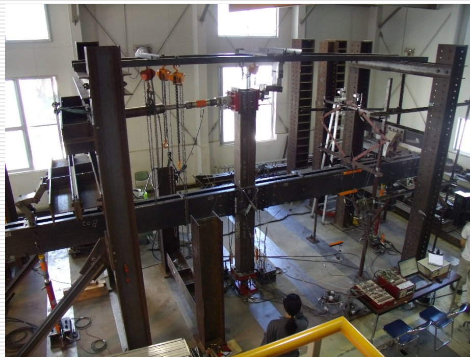
高力ボルトによる柱梁接合部の実大実験
